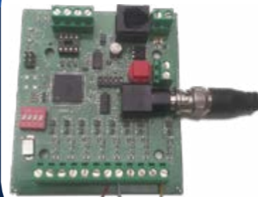
EXI-VID Входной интерфейс охранных датчиков и видео интерфейс - RS485 Габариты : 95x92x19 мм Питание: 12В, 30 мА.
