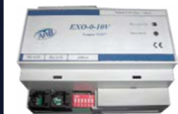
EXO8-0-10V Внешний модуль аналоговых выходов интерфейс - RS485 8 аналоговых выхода напряжения 0-10 В.
