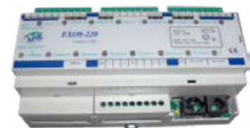
EXO8-220 Внешний релейный модуль интерфейс - RS485 8 выходов 16А, 220В (униполярных).
